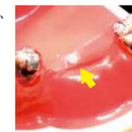
図6 クラウンの間にセラミック球を浮かせてCT撮影を行った。
