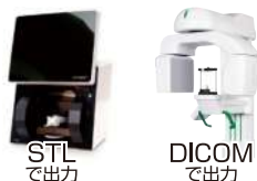
図1 石膏模型などは、卓上スキャナーではSTLデータに、CT撮影ではDICOMデータで出力される。
